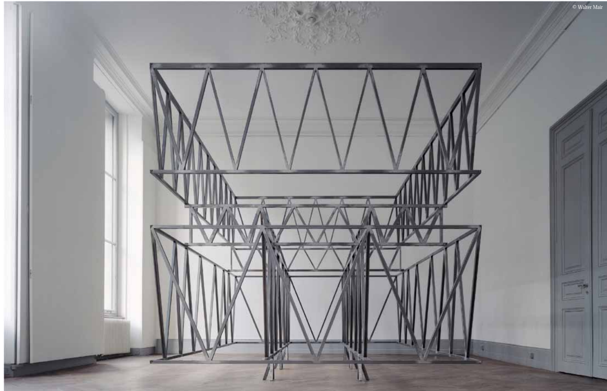
Masstäbliches Modell der Fachwerkstruktur
