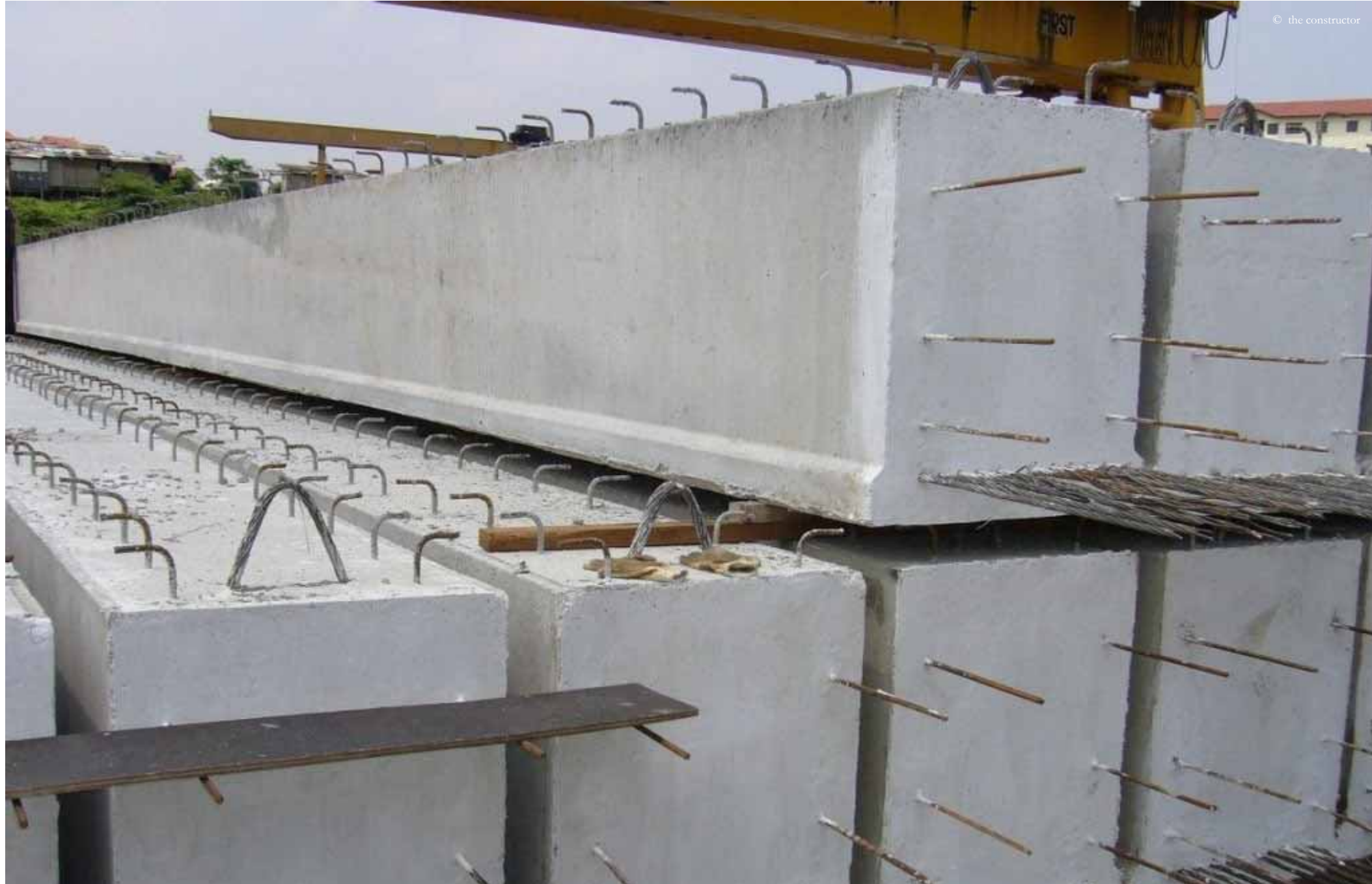
Vorgefertigte und vorgespannte Betonbalken Precast and pre-tensioned concrete beams
