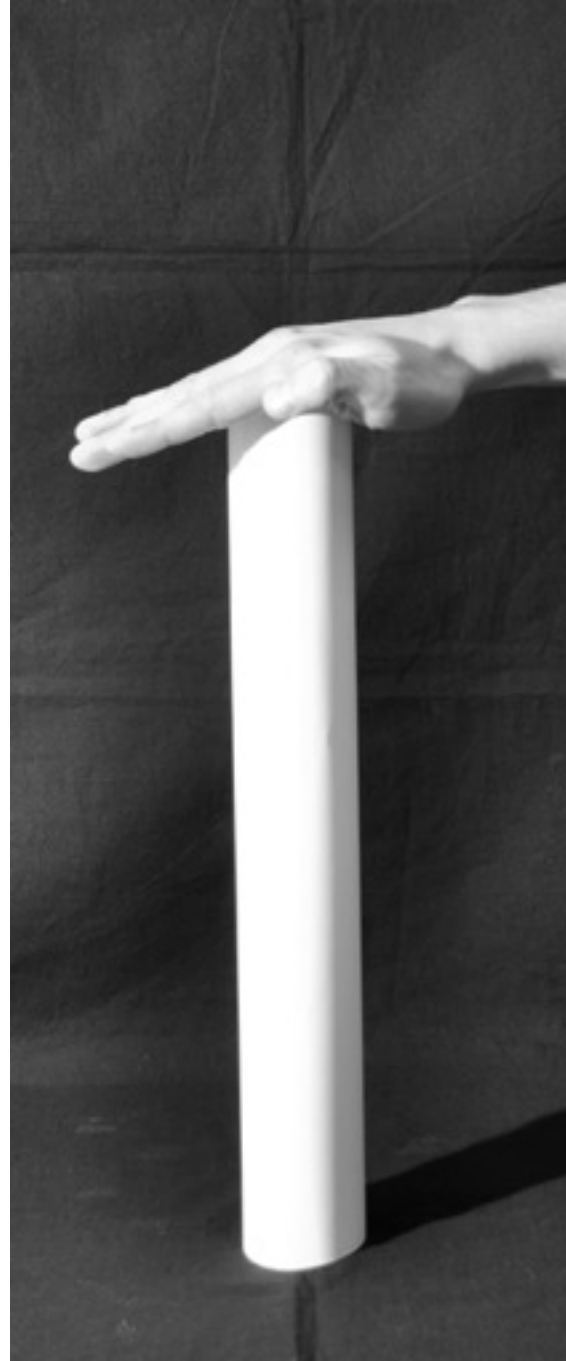
Beulen einer Stütze mit einem sehr dünnwandigen Querschnitt
