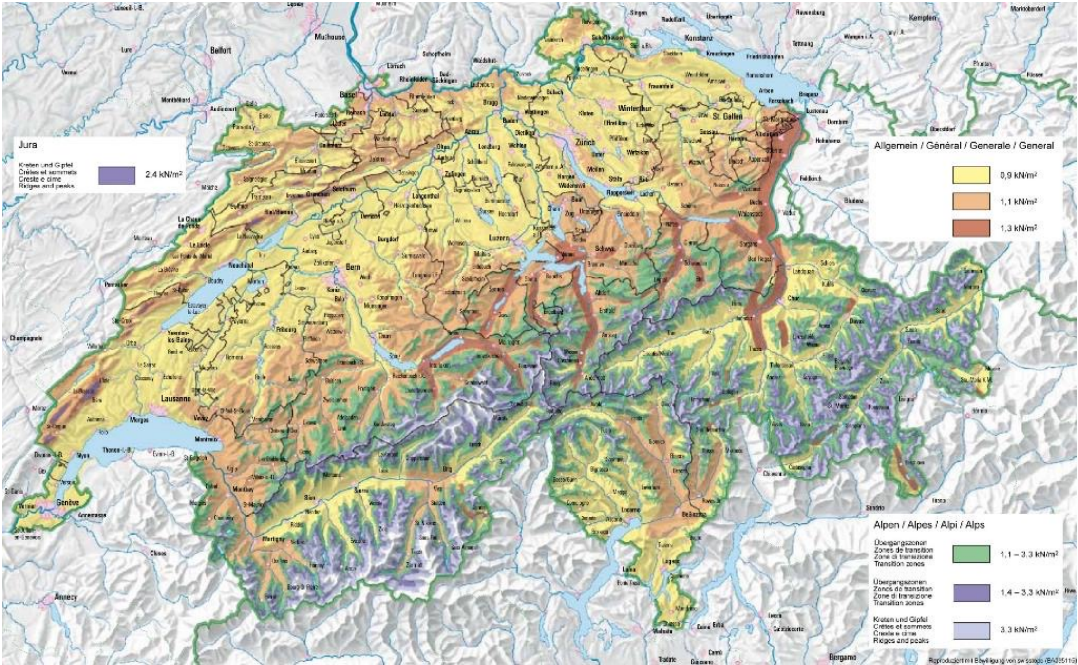
Stärke des Winddrucks auf Gebäude (dynamischer Druck) nach SIA 261
