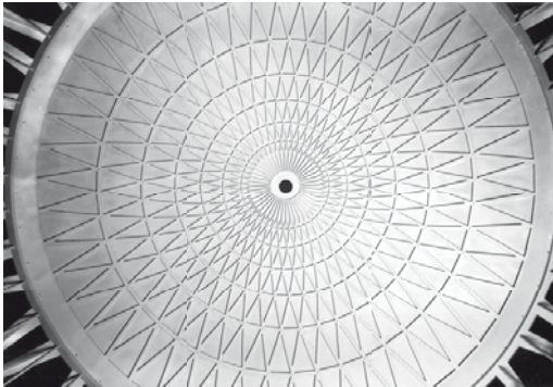
Modell der Arena von Norfolk (Virginia) aus Kunstharz im Mst. 1:50, getestet am Istituto Sperimentale Modelli e Strutture (ISMES) in Bergamo, 1967. (Foto: Archivio Storico ISMES)
